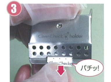
洗浄終了後、「パチッ」と音がするまで下げてホルダーから引き抜き、反応を確認します。
