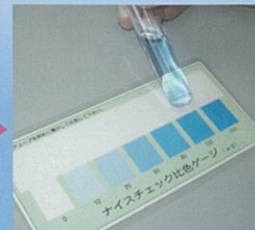
採取した抽出液の色調を専用のゲージを用いて、大まかな蛋白量が確認できます
