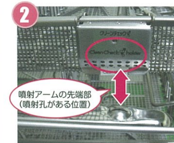
洗浄バスケットにセットします。ウォッシャーディスインフェクタの場合は、噴射アームの先端部が通過する位置、洗浄バスケットの外側に取り付けます。
