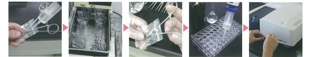
洗浄後の器材を専用の抽出用バックにいれて、特殊抽出液を注入します 抽出バックを70°Cの恒温器で加温し抽出します 抽出バック内で、数回稼働させて、さらに抽出します OPA試薬を添加し反応させます 吸光度を測定して蛋白質量を算出します
