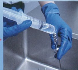
ナイスチェック2液により内部を充分すすぎます
